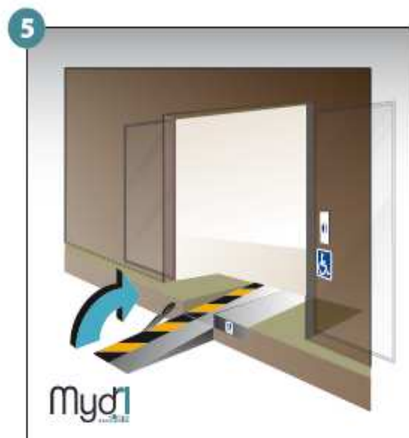
5 - Basculer la poignée qui fera office de chasse roues.
