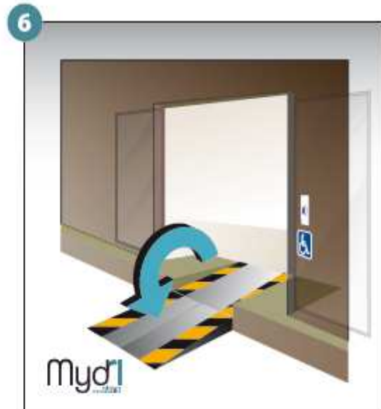
6 - Répéter les opérations pour la deuxième rampe.
